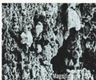
処理前のコンクリート表面拡大写真 (200倍率)
